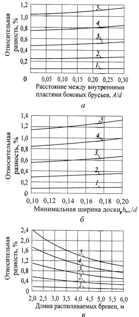
Рис. 2. Изменение относительной разности предельного охвата боковых брусьев от расстояния между внутренними пластами боковых брусьев (а), минимальной ширины доски (б) и длины распиливаемых бревен (в) при различных значениях K : 1 – 1,1; 2 – 1,2; 3 – 1,3; 4 – 1,4; 5 – 1,5
