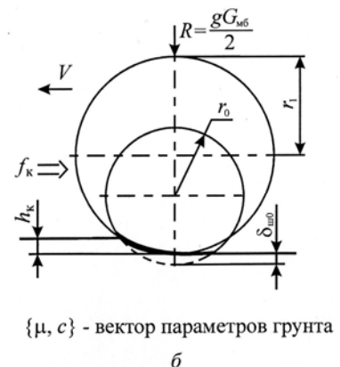
Рис. 1. Расчетные схемы: а – профиль шины с конструктивными параметрами; б – схема качения эластичного колеса мотоблока по волоку
