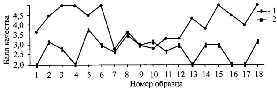
Рис. 2. Оценка качества прозрачного покрытия: 1 – изолирующий грунт; 2 – ПУ изолирующий силер; 3 – ОКСОЛАККА
