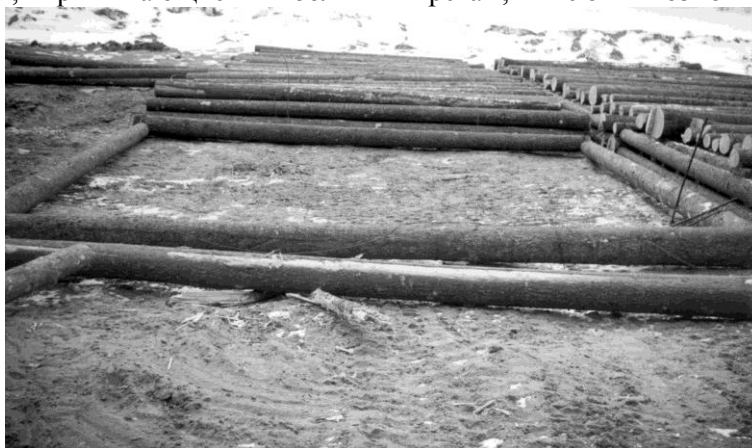
Рис. 2. Изготовление плота из плоских сплоточных единиц на плотбище
