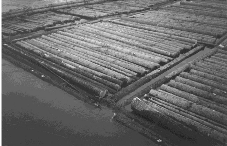
Рис. 1. Плот из плоских сплоточных единиц конструкции АГТУ
