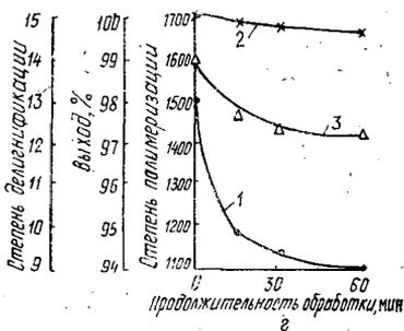
Изменение степени делигнификации (1), выхода (2) и степени полимеризации (3) целлюлозы при обработке перексусной кислотой в зависимости от ее расхода (а), температуры (б), продолжительности обработки при температуре 90 (в) и 40 °С (г).
