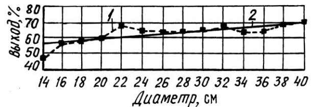
Рис. 4. Изменение выхода пиломатериалов в зависимости от диаметра бревна: 1 – экспериментальная кривая; 2 – расчетная ( y = 1,369x + 52,097 )
