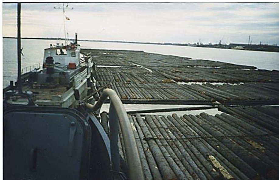
Рис. 5. Плот из плоских сплотовых единиц
