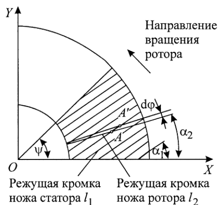
Рис. 1. Расчетная схема расположения ножевого сектора в системе координат: \alpha_1 – угол установки ножей статора; \alpha_2 – угол установки ножей ротора
