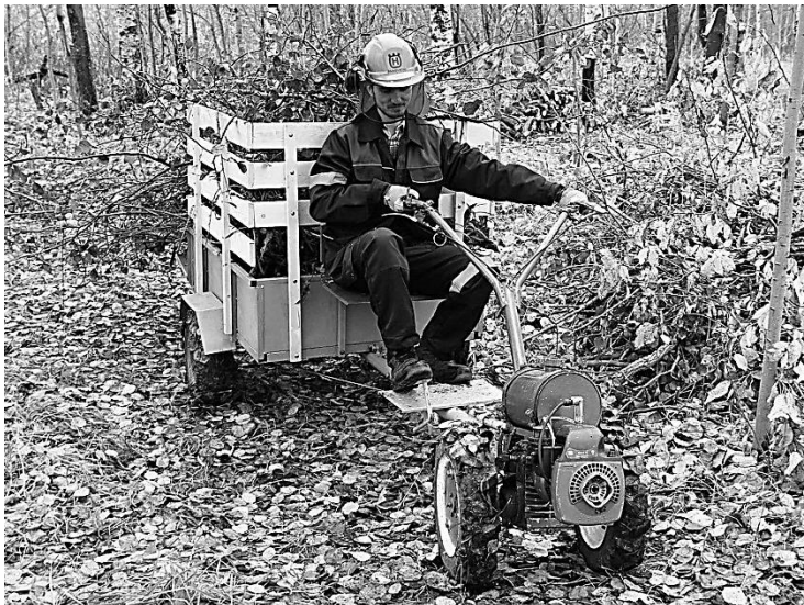
Рис. 1. Вывоз отходов рубки ухода с помощью минитрактора 2К2
