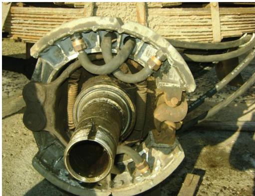
Рис. 3. Установка штуцеров в тормозных колодках
