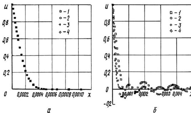
Рис. 2. Распределение температур в стержне в момент времени  $t = 0,001$  с для различного числа удерживаемых членов ряда:  $a$  – решение в экспоненциальных рядах ( $1 - n = 5$ ;  $2 - 10$ ;  $3 - 25$ ;  $4 - 50$ );  $b$  – решение в тригонометрических рядах ( $1 - n = 10$ ;  $2 - 20$ ;  $3 - 50$ ;  $4 - 100$ )
