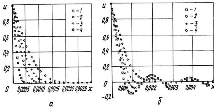
Рис. 1. Распределение температур в стержне для ряда с числом членов  $n = 10$  и различных моментов времени: 1 – 0,001 с; 2 – 0,005; 3 – 0,010; 4 – 0,020; а – решение в экспоненциальных рядах; б – в тригонометрических рядах
