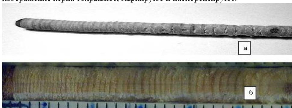
Рис. 3. Общий вид керна (а) и керна, собранный из фрагментов (б)
