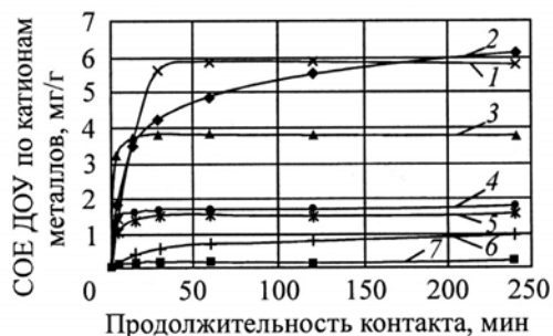
Рис.1. Зависимость СОЕ угля от продолжительности контакта в нейтральной среде: 1 – Fe 3+ ; 2 – Ni 2+ ; 3 – Fe 2+ ; 4 – Pb 2+ ; 5 – Zn 2+ ; 6 – Al 3+ ; 7 – Co 2+
