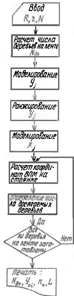
Рис.2. Принципиальная блок-схема работы полноповоротной ЛЗМ
