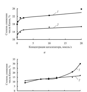
Изменение степени снижения числа Каппа лиственной (I) и хвойной (2) целлюлозы после обработки кислородом при варьировании концентрации катализатора HPA-5-Mn (a: концентрация целлюлозного волокна 1,5 масс. %, рН 3; температура — 90 °C; продолжительность 2 ч) и температуры (6: концентрация целлюлозного волокна — 1,5 масс. %; концентрация HPA-5-Mn — 2,0 ммоль/л; рН 3; продолжительность — 2 ч)
