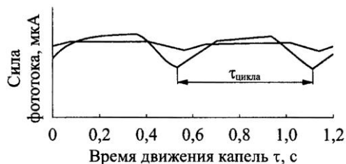
Рис. 1. Циклограммы истечения жидкости из сопла (1) и движения группы капель (2)
