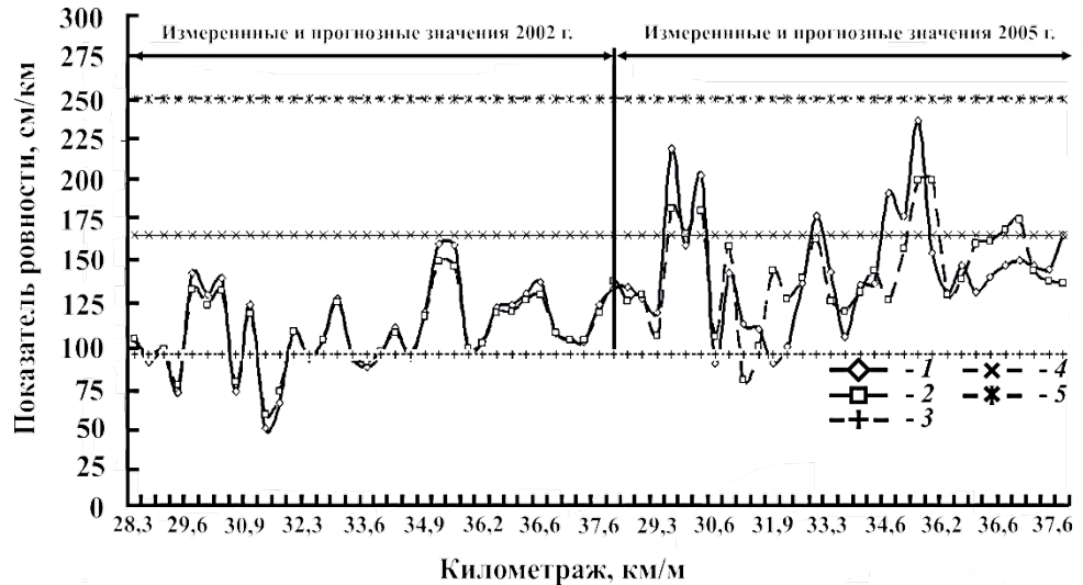
Рис. 4. Измеренные (1) и прогнозные (2) значения показателя ровности для различного состояния дорожного покрытия: 3 – отличное, 4 – хорошее, 5 – требующее ремонта
