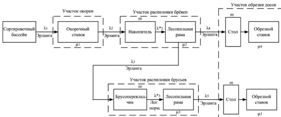
Рис. 1. Сетевая модель поточной линии производства пиломатериалов ( \lambda_{1-5} – интенсивность входящего потока требований на соответствующих участках; m – допустимое количество требований, находящихся в очереди на обслуживании (обработке);
