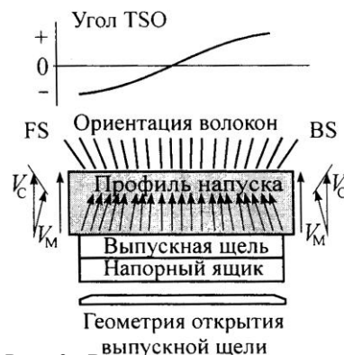
Рис. 3. Влияние ширины открытия выпускной щели напорного ящика на ориентацию волокон по ширине полотна и профиль угла TSO ( V_M < V_C )
