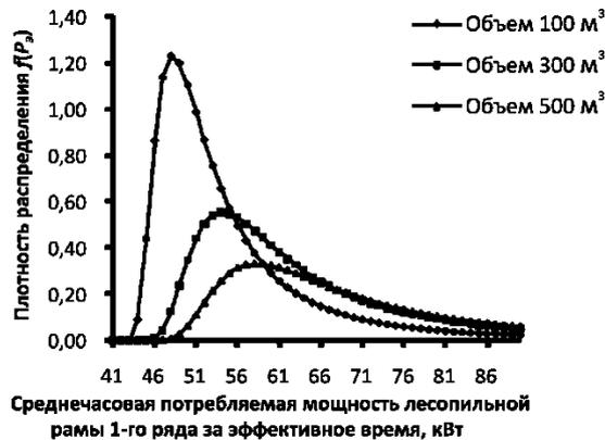
Рис. 2. Плотности распределения вероятностей среднечасовой потребляемой мощности лесопильной рамы 1-го ряда
