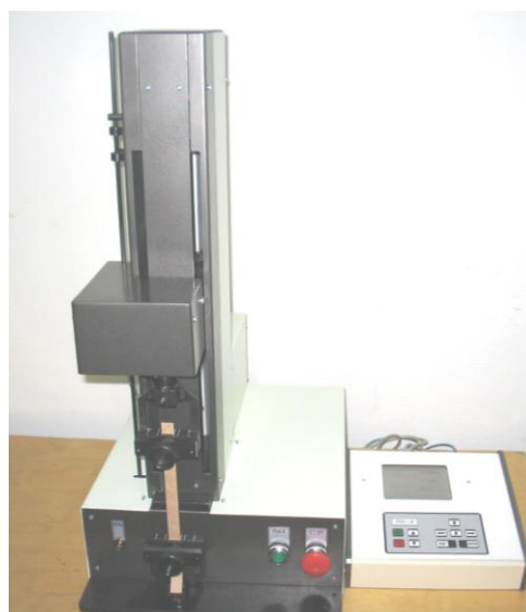
Рис. 1. Испытательная машина «Тестсистема-105»
