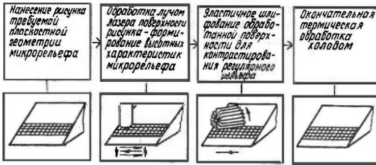
Рис. 2. Схема лазерного упрочнения инструмента с созданием регулярных микрорельефов
