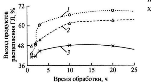
Рис. 2. Выход продуктов расщепления в зависимости от времени обработки технических гидролизных лигнинов 20 %-м раствором АсВг в АсОН при температуре 50 °С: 1 – Тавдинский ТГЛ, 2 – Лобвинский ТГЛ, 3 – Кировский ТГЛ
