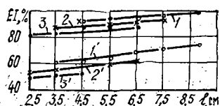
Рис. 9. Влияние изменения длины образца на измеряемую жесткость бумаги при изгибе для различных значений деформирующей силы: 1, 1' — 3,06; 2, 2' — 6,12; 3, 3' — 15,30 мН; 1, 2, 3 — образцы сульфатной небеленой целлюлозы; 1', 2', 3' — образцы сульфитной беленой целлюлозы
