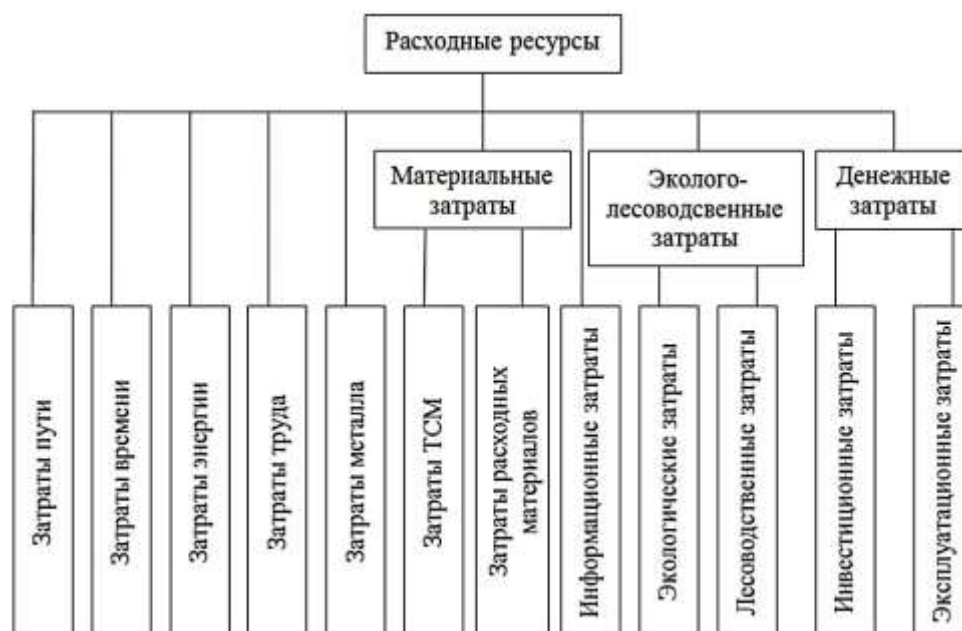
Структура расхода ресурсов при выполнении лесохозяйственных технологических процессов (ТСМ – топливно-смазочные материалы)
