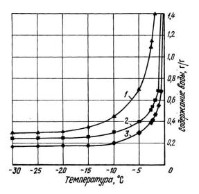
Рис. 4. Зависимость содержания незамерзшей (связанной) воды в образцах от температуры (см. обозначения на рис. 3)
